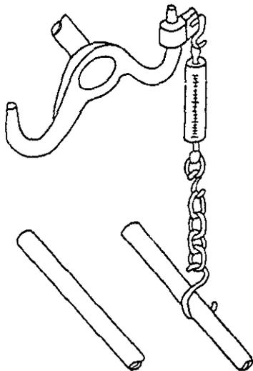
Рис. 1. Схема крепления приспособления для измерения рулевой машины крена
